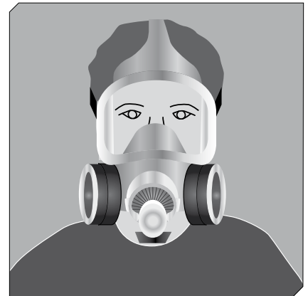
(D) Full-face, particulate filter (cartridge) respirator.
